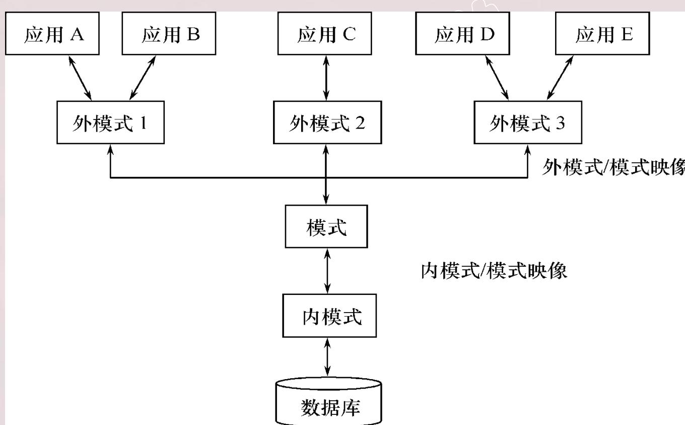
图1.16 数据库系统的三级模式结构
